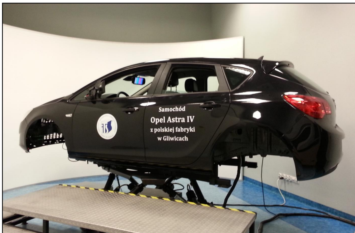
Rys. 4. Kabina symulatora wraz systemem ruchu
