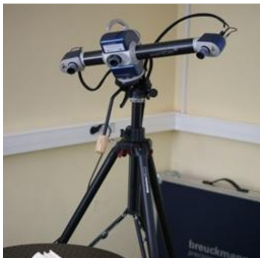
Rys. 6. Pomiary skanerem optycznym światła białego
