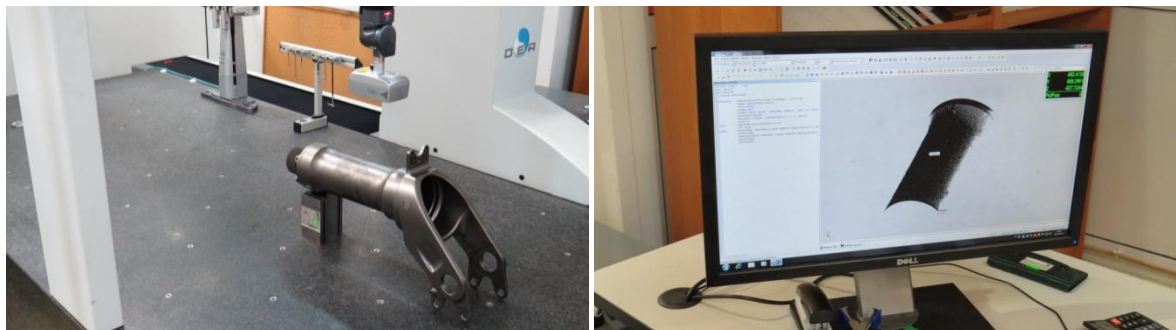
Rys. 5. Skanowanie laserowe na maszynie współrzędnościowej
